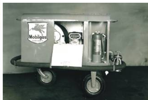
Matériel d'avitaillement (Dispenser) à Abidjan
