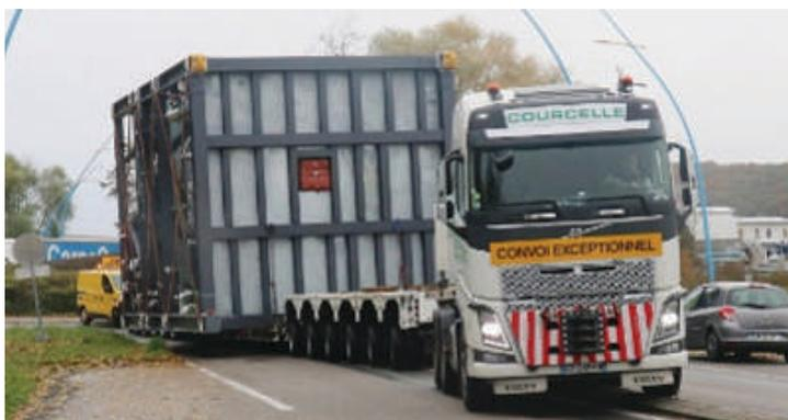
La plus grosse pièce pesait 85 tonnes et mesurait 6 mètres de haut, ce qui a notamment nécessité de creuser la route pour passer sous des installations.
